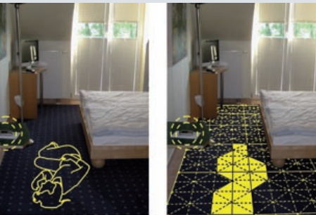
Abb. 5: SensFloor® triggert einen Notruf, wenn eine gestürzte Person nicht wieder aufsteht.
