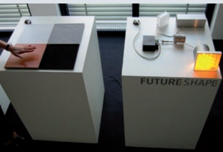
Abb. 6: Über ein achtfach Funkrelais können 110/230 V-Verbraucher direkt über den SensFloor angesteuert werden.
